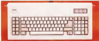
La tastiera dell'AT è di struttura portatile. Si differenzia da quella del PC per il layout dei tasti: una non serve in italiano e per la presenza delle spie di Lock.
